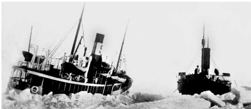
Sankt Erik assisterar nödställd i ismassorna. Isbrytaren har ett förskepp av så kallad svensksundstyp, det vill säga, med vinklad stäv som får henne att glida upp på och krossa isen.
