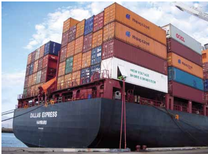
Inga ombyggnader krävs ombord med containersystemet. Allt som behövs på fartygssidan för landanslutning av el finns i containern. Foto SAM Electronics.
