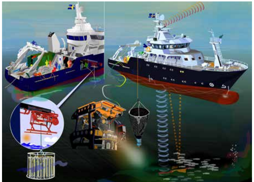
R/V Skagerak , där R/V står för Research Vessel. Akterdäcket är en stor arbetsyta. Det brandgula föremålet är en fjärrstyrd undervattensfarkost. Illustration Göteborgs universitet.
