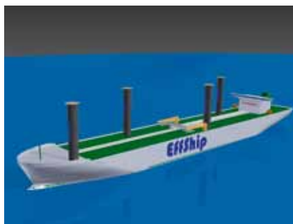
Flettnerrotorerna skymmer inte sikten på samma sätt som segel. De är sju till tio gånger mer effektiva än segel med samma yta. Illustration SSPA
