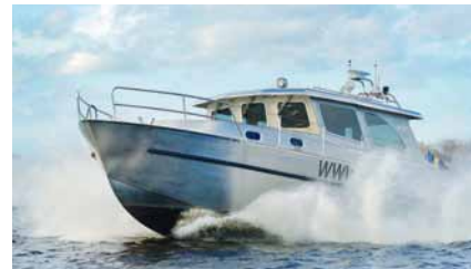
Båten Elvira är det första fartyget som byggts i materialet. Hon väger 4,5 ton. Foto: Swedish Steel Yachts
