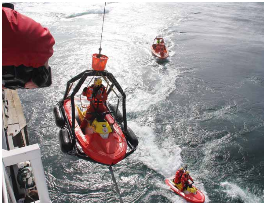
Sjösättning och ombordtagning av Rescuerunnern går enkelt med den framtagna vaggan.
