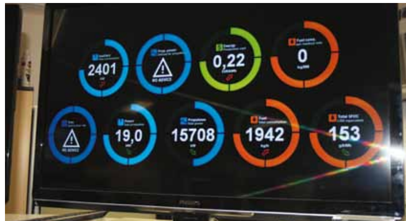
Beslutsstödsystemet Emma har utvecklats av ABB. Det är kopplat till elcentralen ombord och visar fartygets energiförbrukning i realtid.
